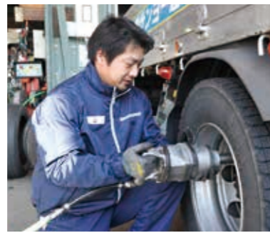
「タイヤの締め過ぎは逆に緩みの原因になります。熟練であっても助に頼るのではなく、法令を遵守し専用器具を使って数値を確認しながら慎重に作業を進めます」
