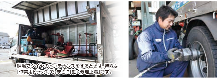
「タイヤの締め過ぎは逆に緩みの原因になります。熟練であっても助に頼るのではなく、法令を遵守し専用器具を使って数値を確認しながら慎重に作業を進めます」
